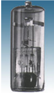
Abbildung 3.4: Quecksilberdampflampe als Beispiel für eine Linienquelle
