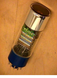
Abbildung 3.12: Technische Ausführung eines Photomultipliers
