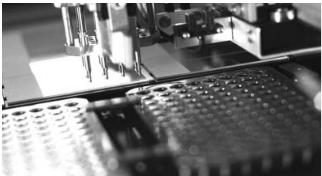
Herstellung von DNA-Chips mit dem Affymetrix System
