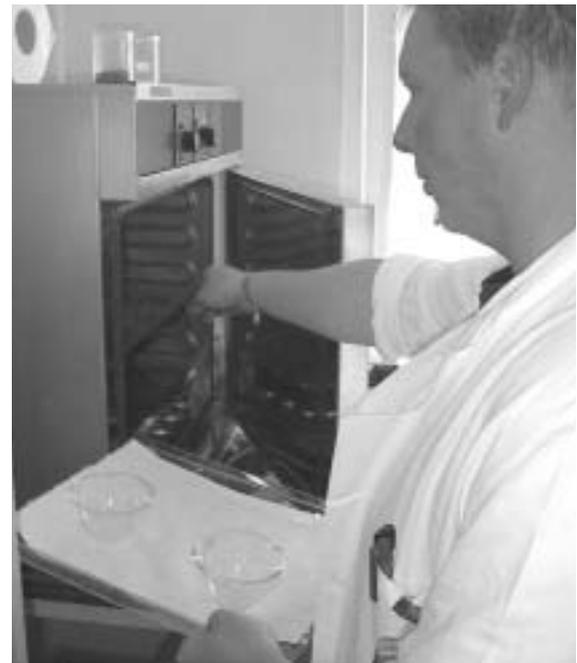
Nach dem Reinigungsprozess wird die Spül-lösung mit den entfernten Partikeln in Abdampfschalen eingeeengt und dann aus-gewogen.
