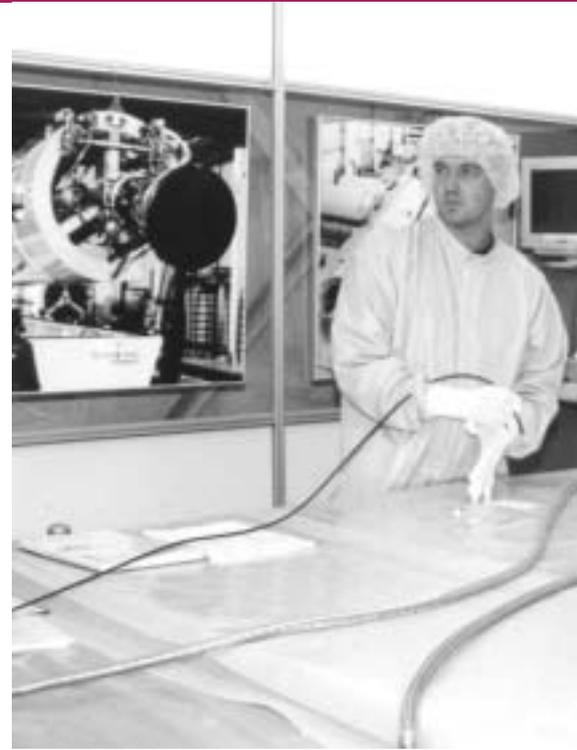
Anlage zur Spülung der Rohrleitungssysteme unter Re
