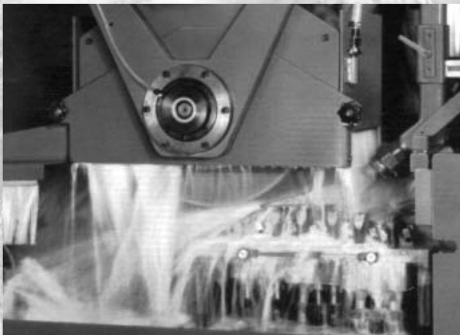
Kühlschmierstoff im Einsatz an einer Schleifmaschine
