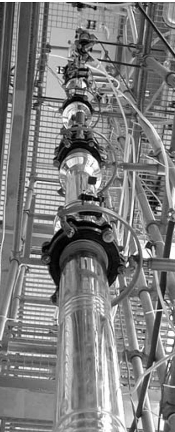
Pilotanlage für reaktive Rektifikationsprozesse
